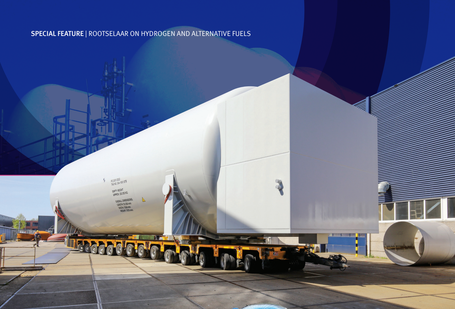
© Rootselaar | Maritime LNG fuel tank
